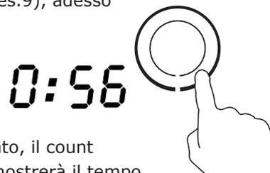
6. Quando il tempo residuo è stato impostato, il count down inizierà immediatamente. Il display mostrerà il tempo rimanente e il timer lampeggerà per 5.
